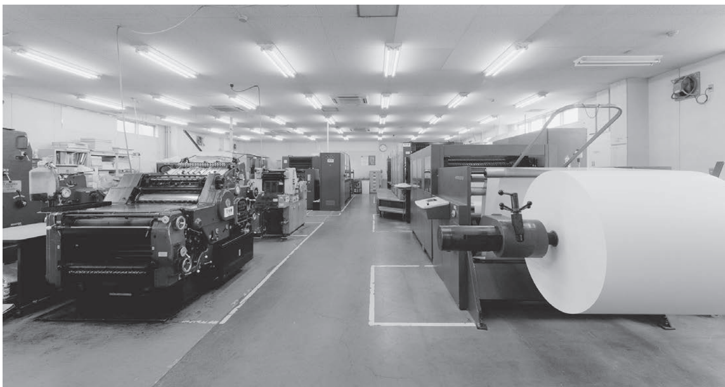
オフセット印刷工場：右がハイデルベルグ SM-102カットスター、左がハイデルベルグ KORD
