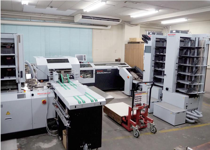
製本工程の製造原価低減に向けて少ない人員で稼働できるステッチライナーを導入
