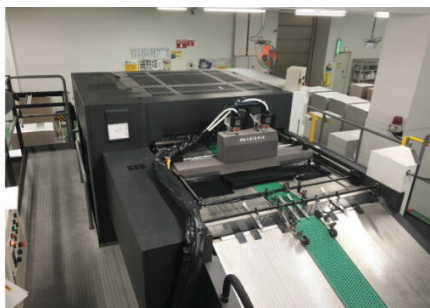
紙面昇温装置「SION」を印刷機のフィーダー部に取付けるだけ
